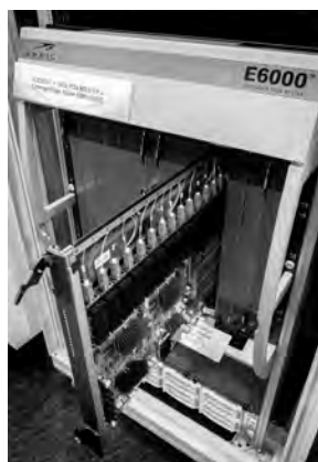
CCAPプラットフォーム「E6000 CER」から新製品の10G-EPON OLTモジュールを引き出したところ
